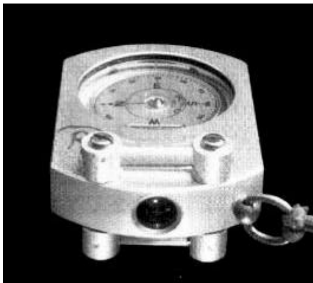
Fig. 1: Boussole SUUNTO avec un cylindre de verre comme dispositif complémentaire de visée. La lumière issue du point à viser apparaît comme une ligne verticale dans le cylindre de verre. Ce dispositif améliore la précision des visées en forte pente, en évitant que la prolongation visuelle du repère de visée s'écarte de la verticale. Les erreurs qui peuvent en découler sont plus importantes qu'on ne le pense, surtout pour des visées en forte pente (plus de 30g). On trouve une description détaillée du système et du montage chez Weissensteiner & Trüssel (1991). Photo M. Trüssel..
